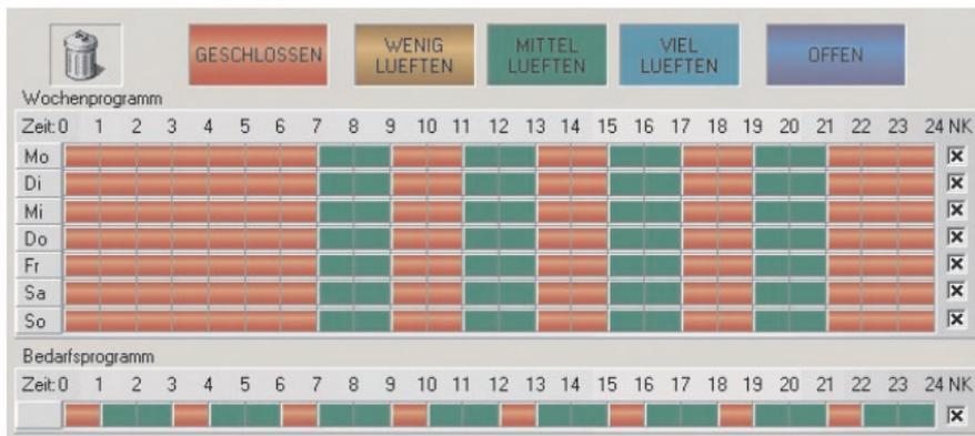
**Manuelles Öffnen und Schließen** ist immer möglich, auch wenn keines der beiden Lüftungsprogramme aktiv ist. Geben Sie einen manuellen Befehl ein, obwohl die Lüftungsautomatik läuft, so gilt dieser Befehl für eine definierte Zeitspanne (Handbedienungszeit) und danach kehrt das FLS wieder in die Lüftungsautomatik zurück. Die Sicherheitskriterien (Witterungsbedingungen am Fenster) werden jedoch immer berücksichtigt, es sei denn, Sie wollen ein Öffnen des Fensters erzwingen (siehe Kapitel 4.5).
